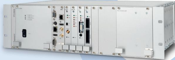
Der ITC2800 ist die neueste POCSAG-Paging-Basisstation in der ITC-Produktpalette. Bei der neuen Produktgeneration wurden erhebliche Anstrengungen unternommen, um die TCO (Total Cost of Ownership) zu senken. Dies wird vor allem durch das neue Netzteil (PS19) erreicht, das die Energieeffizienz des Geräts optimiert, was zu einer Schonung der natürlichen Ressourcen führt. Diesbezüglich bietet die AC-Version mehrere Vorteile gegenüber der vorherigen Generation. Dazu gehören:
