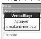
Pour débloquer le verrouillage du clavier, pressez simultanément les deux touches de navigation RET et AV.
