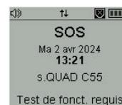
Pour lancer le test de fonctionnement, il faut ouvrir le menu principal en appuyant sur la touche OK. Faites défiler avec les touches de navigation jusqu'à ce que l'option de menu « Test de fonctionnement TPA » apparaisse et confirmez en appuyant sur la touche OK.
