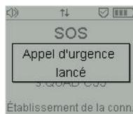
Cette fonction peut être activée/désactivée par le porteur lui-même via l'option de menu « Détection de chute/d'homme mort ». Pour le pack « DGUV 112-139 », cette fonction ne peut pas être désactivée.
