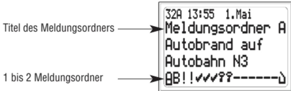
Je nach Programmierung kann der DE925 maximal zwei Meldungsordner aufweisen. In der Meldungsübersicht wird bei der Auswahl eines Ordners der Titel des Meldungsordners angezeigt. Um die Meldungen im Meldungsordner anzuzeigen, drücken Sie die Bestätigungstaste. Mit Hilfe der unteren Navigationstaste können Sie anschliessend die Meldungen lesen.
